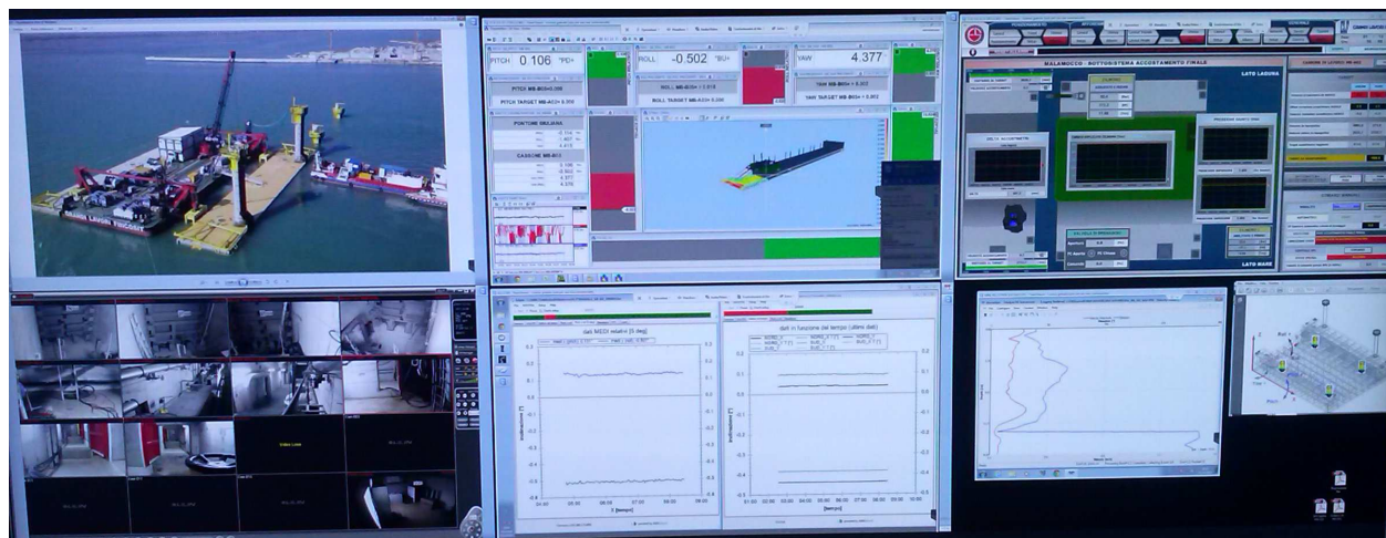
Sistema di automazione per il varo alloggiamenti paratoie progettato per la Grandi Lavori Fincosit
